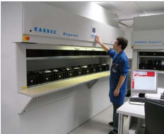
Almacenaje de material electrónico sensible mediante acabados anti-estáticos (ESD)
