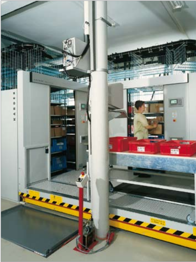
KARDEX Horizontales en un centro de distribución de artículos no alimentarios. 4 Kardex Horizontales con una plataforma elevadora forman la estación de trabajo para aproximadamente 15.000 artículos.
