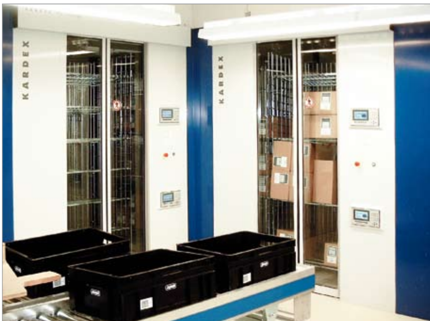
La pantalla luminosa de la mesa de agrupación de pedidos indica la cantidad del artículo correspondiente.
